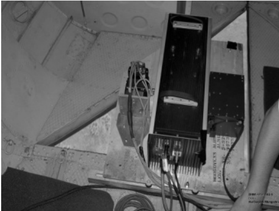
Abb. 2: System während der Befliegung RGB, Laser, INS (v.l. n. r.)
