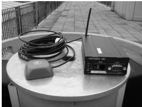
Abb. 2: Ausrüstung für den Post-Processing-Betrieb
