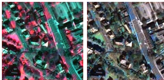
Abb. 2: Ergebnisse der Brovey Transformation (HRSC-A pan/Quickbird ms). li.: ir, r, g : r, g, b; re.: r, b : r, g, b. Größe des Ausschnittes: 200 * 200 m.
