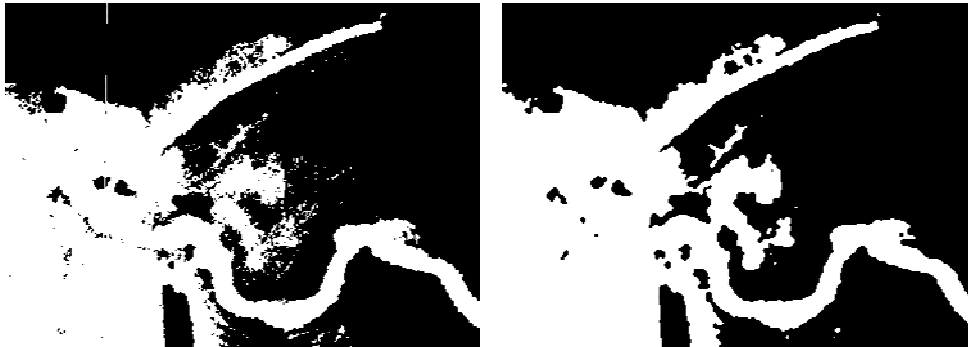
Abb. 2: Ergebnis der 3D-Verschneidung der Wasserspiegellage mit dem Laser-DGM vor (links) und nach (rechts) Anwendung eines Majority-Filters im Mündungsbe- reich der Wesenitz in die Elbe
