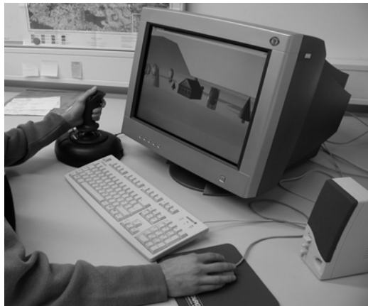
Abb. 2: Desktop-basierte multimodale Testkonfiguration: Manipulation von Geobjekten mit haptischer Maus; Navigation mittels Joystick; auditives Feedback
